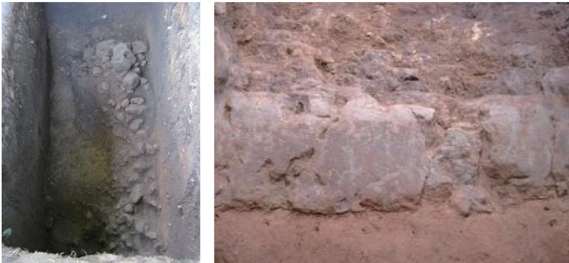
写真4 掘り込まれた硬砂層とその残骸（左）、硬砂層断面のアップ（右）
