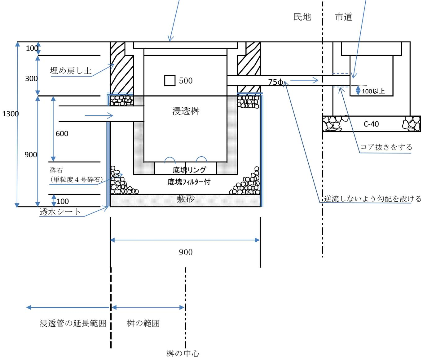
※ 浸透管の延長を集計する時は、浸透枵の浸透範囲を考慮してください。
