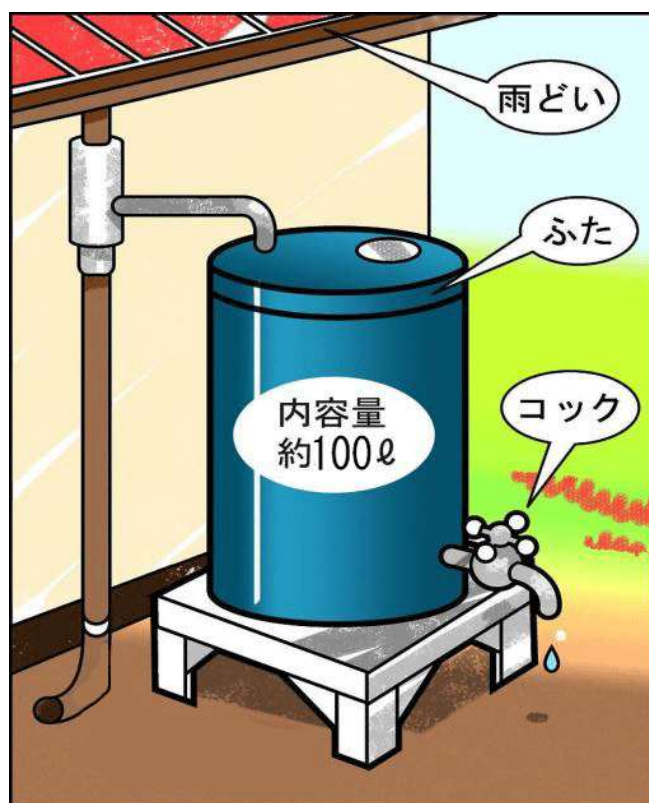
【雨水貯留槽の新設例】
