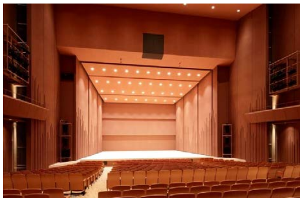
【ホール舞台（反響板設置）】
