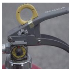
× 表示装置の脱落
