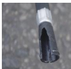
× ノズルの破損
