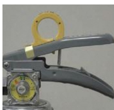
× レバー支えの脱落
