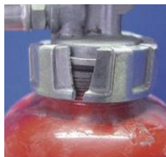
× キャップの破損
