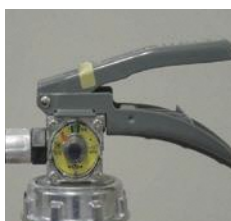
× 安全栓の脱落
