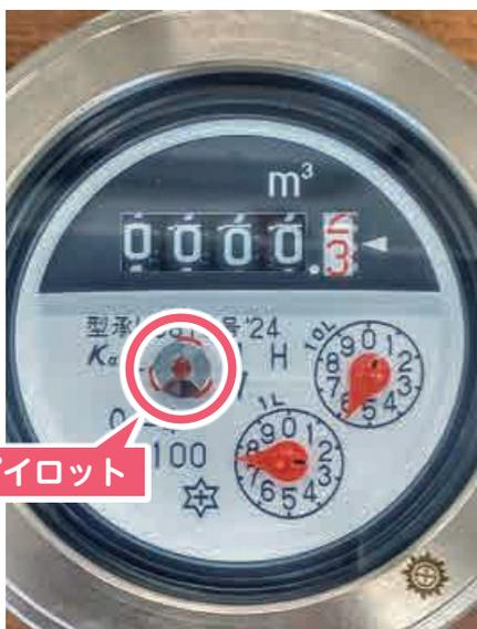
宅地内の蛇口を全て締めても水道メーター中央のパイロットが回転している場合は、漏水により料金が高額になる可能性があります。
